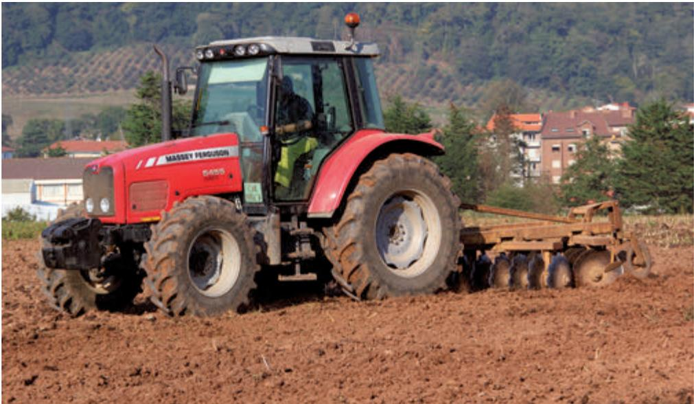
Figura 14: Labor de grada de discos.
