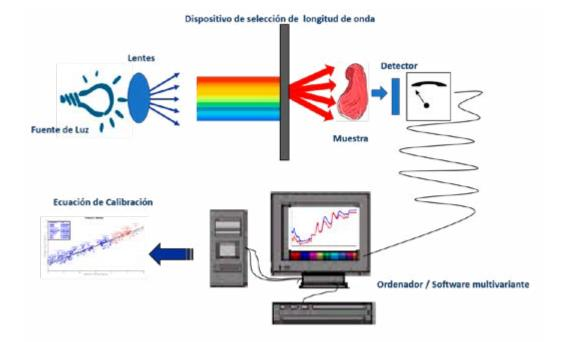
**Figura 3.-** Esquema de las distintas partes y procesos de un equipo NIR.
