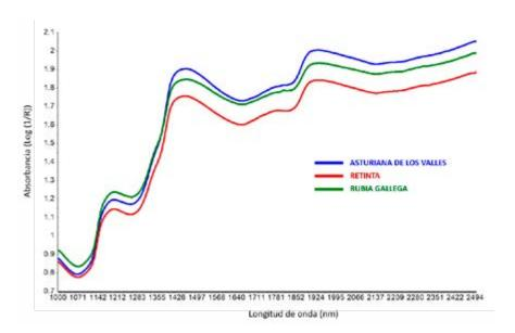
cuantificar dicha absorción de energía es a partir de la medida de la energía reflejada (A = log (1/R))o transmitida (A = log (1/T))por la muestra, donde R y T son el valor de reflectancia o transmitancia respectivamente. La representación gráfica de los valores de absorbancia de la muestra a las diferentes longitudes de onda en el rango NIR (750nm-2500nm) dará lugar a una curva denominada espectro NIR.
