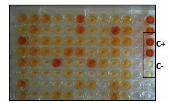
Figura 4.-Placa de resultados de 80 sueros de cabra procedentes de Pola de Laviana (Asturias) analizados mediante el ELISA basado en el antígeno Ssλ20ΔB3. C+, suero control positivo; C-, suero control negativo. El 21% de los sueros analizados resultaron positivos indicando que las cabras estaban infectadas o habían estado en contacto con el ácaro, lo cual supone una amenaza potencial para especies simpátricas.
