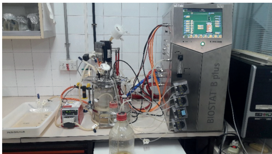
Figura 61. Obtención de biomasa de levadura por lote alimentado o “fed-batch”.
