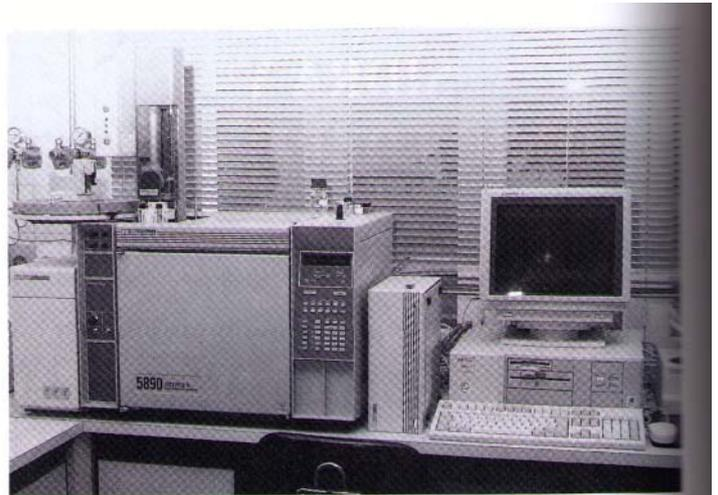
Cromatógrafo de gases para el control de aromas.
