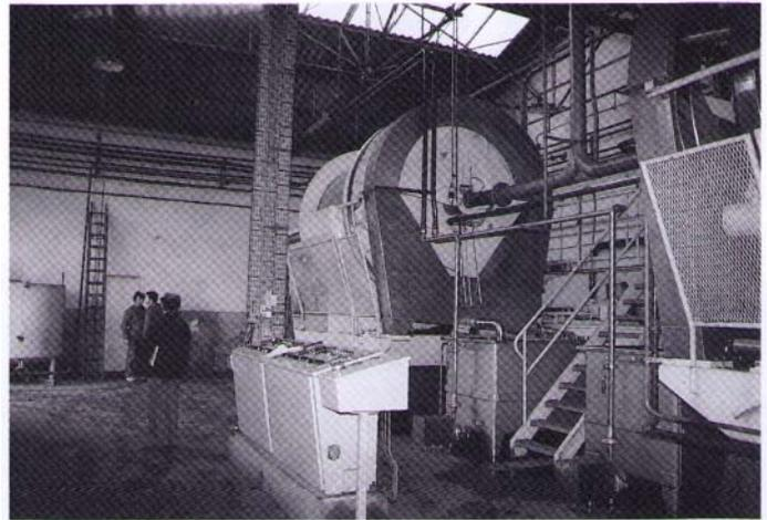
Prensa hidráulica de extracción rápida.
