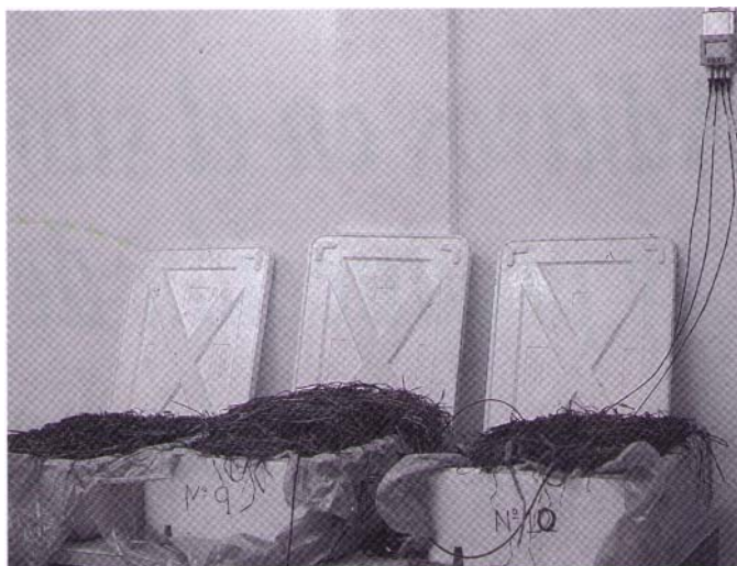
Cámara de ambiente controlado para determinar la velocidad de deterioro del ensilado al contacto con el aire.
