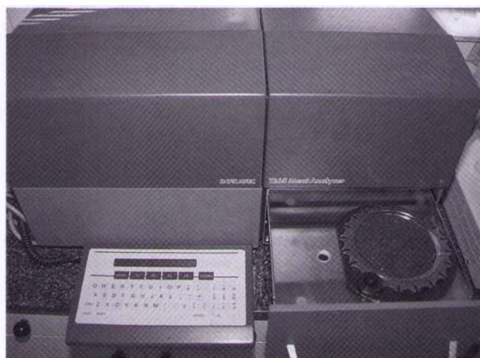
Equipo Infratec Meat Analyzer para determinar la composición química de la carne.
