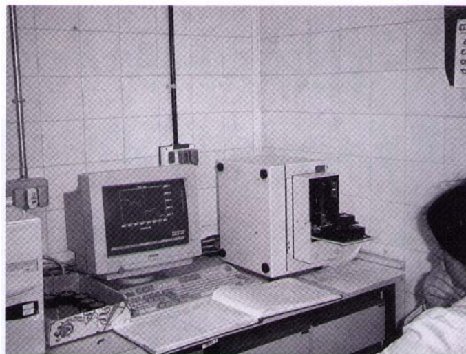
Equipo de reflectancia en el infrarrojo cercano para el análisis de la calidad de los ensilados.
