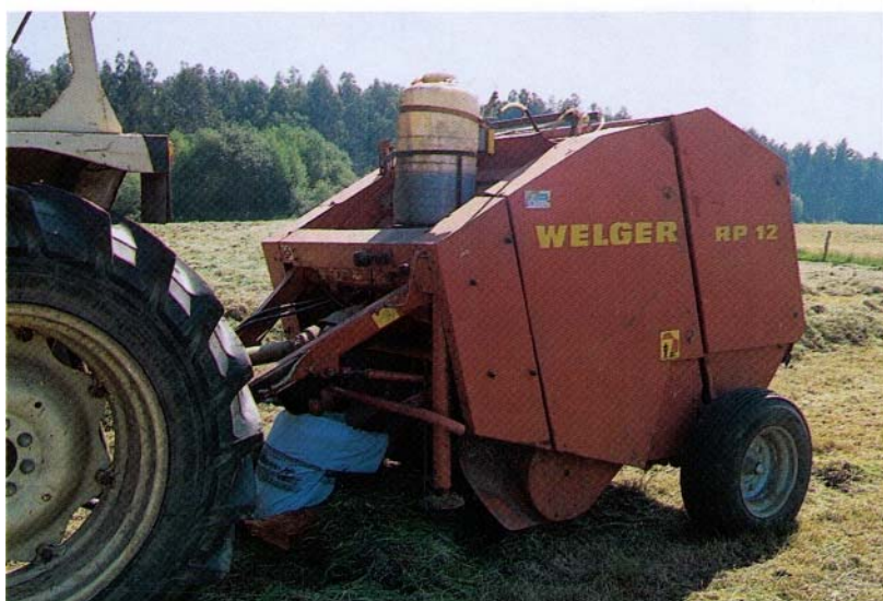
Sistema de dosificación de aditivos acoplado a la rotoempacadora.
