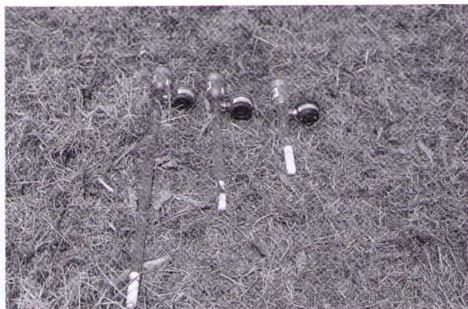
Tensiómetros de distintos tamaños.
