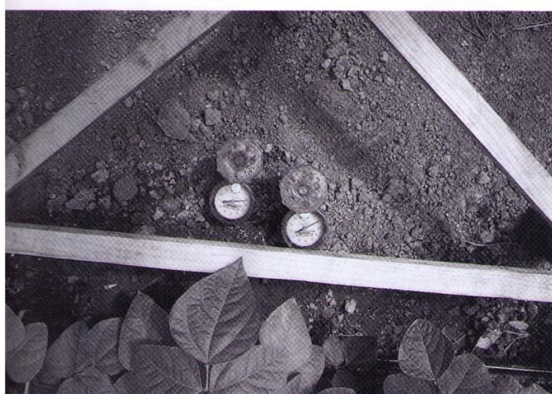
Estación con dos tensiómetros. El marco de madera sólo tiene la finalidad de proteger los tensiómetros.
