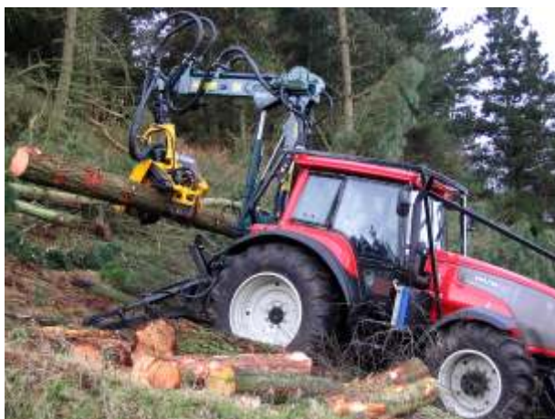
Procesadora manejando los troncos.
