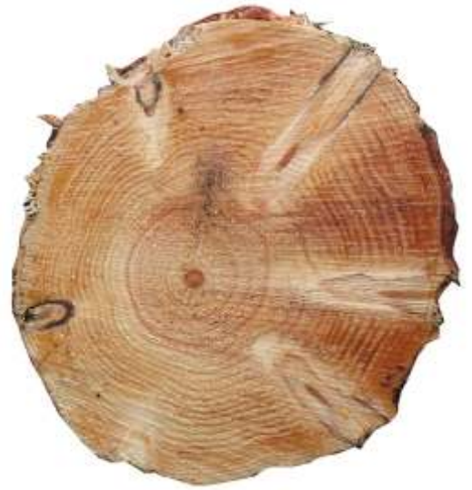
Corte transversal de un tronco en el que se aprecia la formación de nudos que origina madera de mala calidad.
