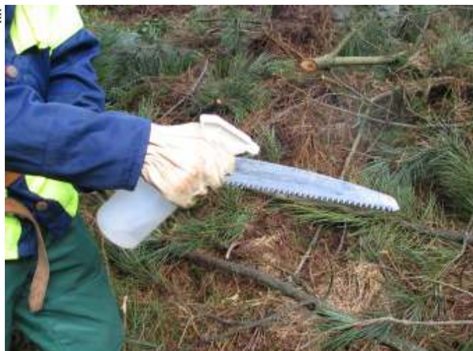
Pulverizando con alcohol sobre la hoja de un serrucho de poda para su desinfección.
