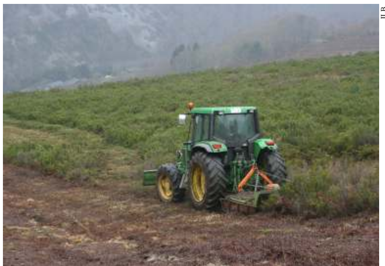
Desbrozadora de cadenas acoplada a un tractor.
