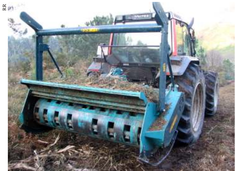
Desbrozadora de martillos acoplada a un tractor.
