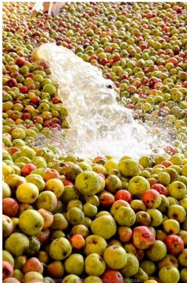
Selección mediante floteación en la cinta mecánica. / IRTA SEVILLA
